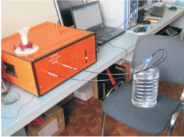
Рис. 1. ИК фурье-спектрометр с выносным оптоволоконным зондом (в процессе измерения спектров исследуемых жидкостей)
