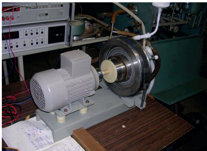
Рис. 6. Модуль магнитного подшипника на стенде для статических и динамических испытаний
