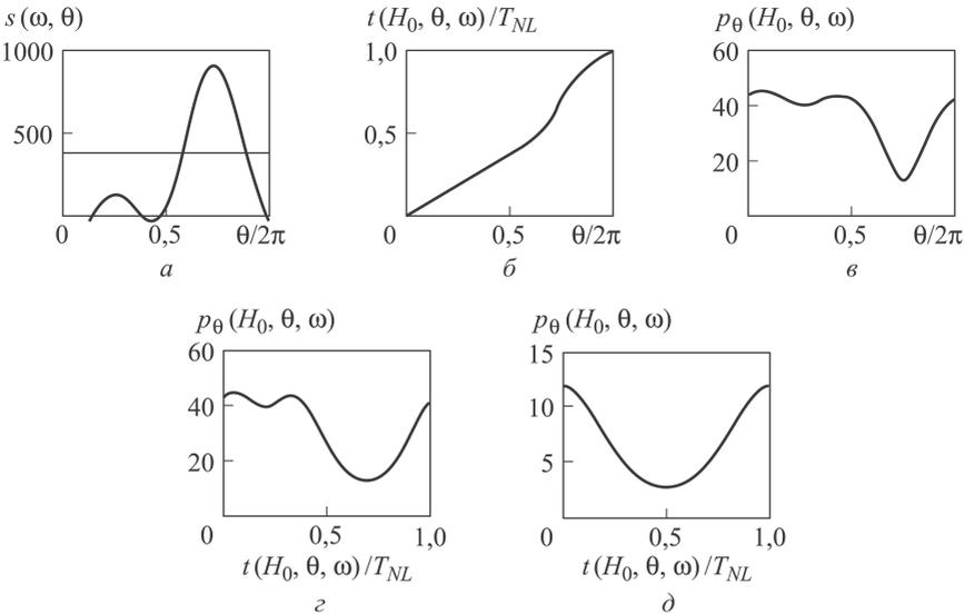
**Рис. 3.** Зависимости определения нижней границы начальной энергии, обеспечивающей вращательное движение маятника (*а*), времени от угла поворота при вращательном движении маятника (*б*), обобщенного импульса от угла поворота при вращательном движении маятника (*в*), обобщенного импульса от времени (*г*), угловой скорости вращения от времени (*д*) маятника на вращающемся основании
