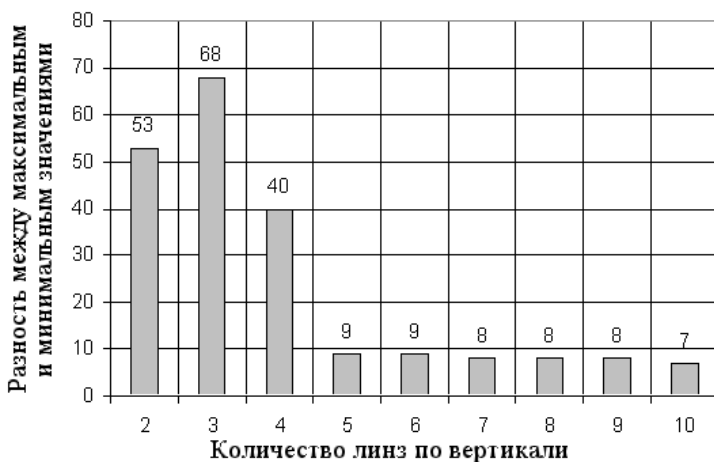
Рис. 17. Неравномерность освещения модулятора изображения (кадра) в зависимости от количества линз в линзовом массиве (в столбце), т.е. по вертикали
