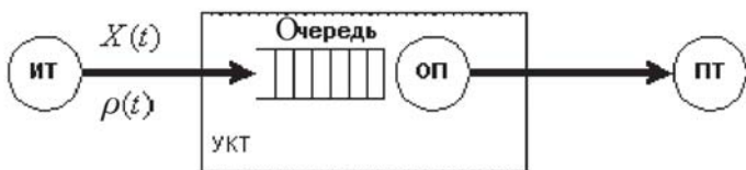
Рис. 1. Функциональная схема управляемого коммутатора в терминах СМО
