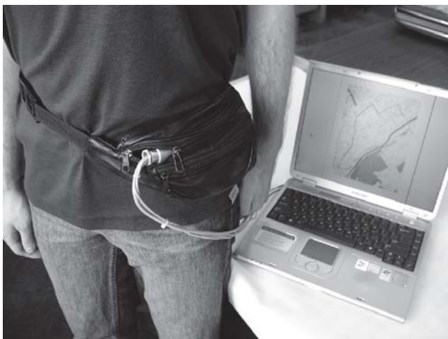
Рис. 3. Крепление персонального навигационного комплекса на теле человека
