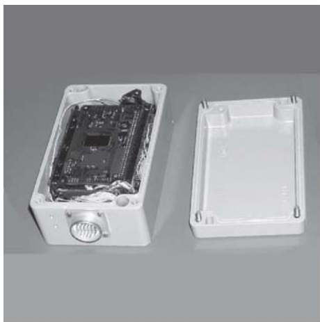
Рис. 2. Система “КомпаНав-2”: а – прочный корпус, б – “легкий” корпус
