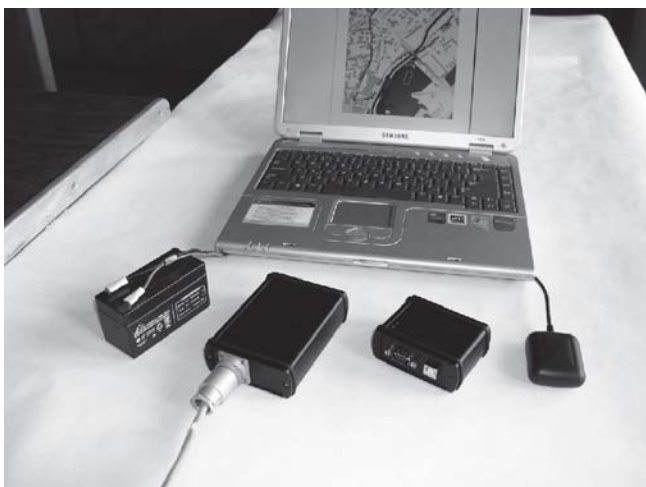
Рис. 1. Состав персонального навигационного комплекса
