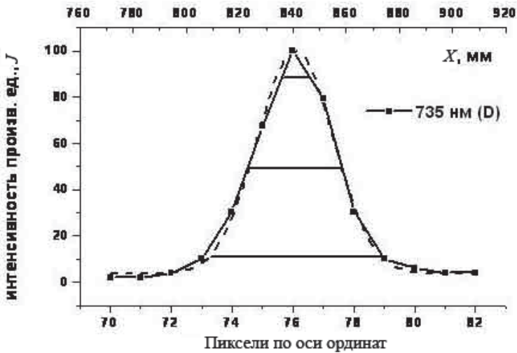
Рис. 9. X -сечение функции распределения интенсивности изображения от точечного монохроматического источника — сплошная кривая; штриховая — аппроксимация функцией Гаусса
