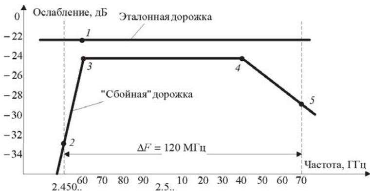
**Рис. 14.** Реакция бесконтактного датчика сбоев на эталонную (точка 1) и “сбойные” (точки 2–5) дорожки МПП
