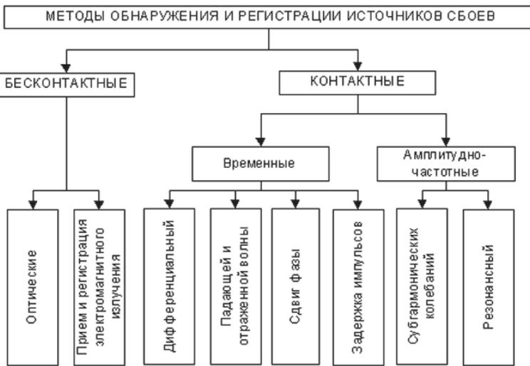
**Рис. 3. Классификация методов обнаружения и регистрации источников сбоев**
