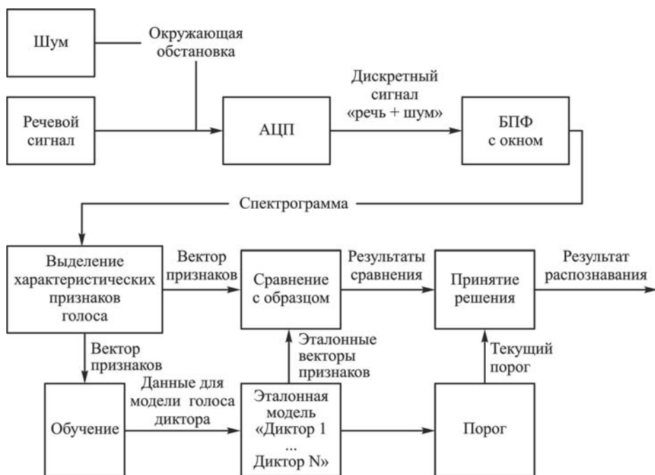
Рис. 1. Классическая модель системы распознавания голоса диктора
