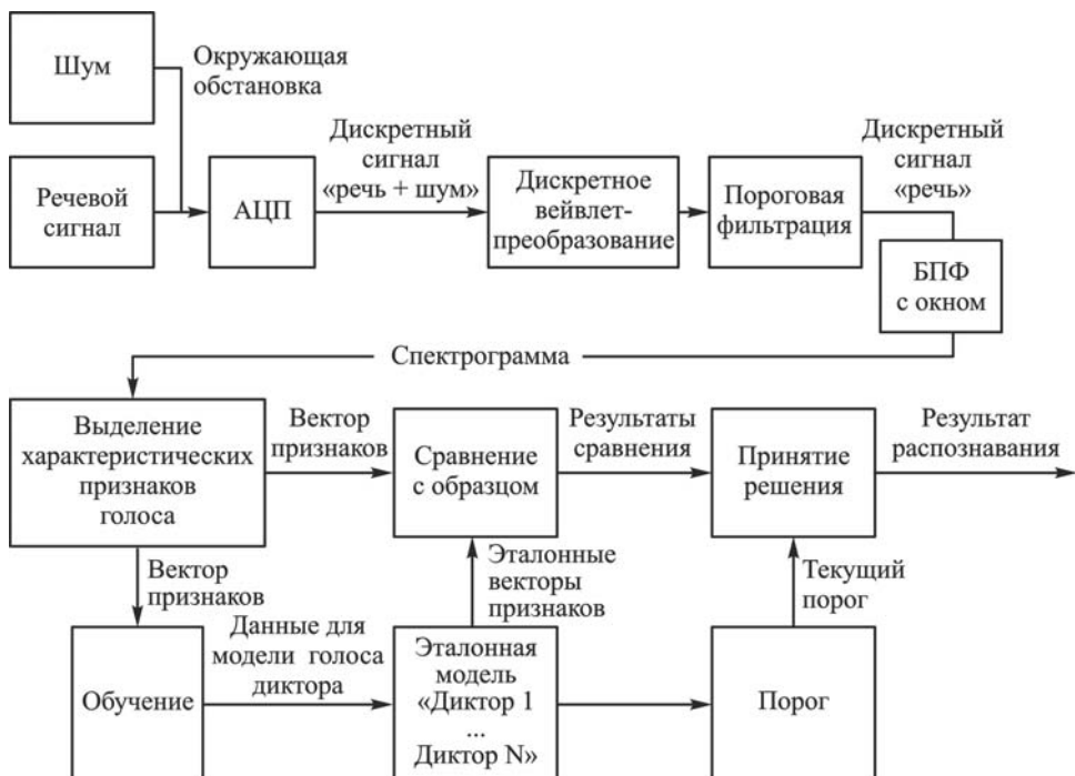
Рис. 2. Модель системы распознавания голоса диктора с разделенными (а) и совмещенными (б) задачами фильтрации и распознавания
