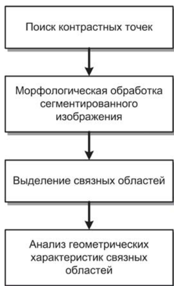
Рис. 11. Последовательность поиска малоразмерных объектов
