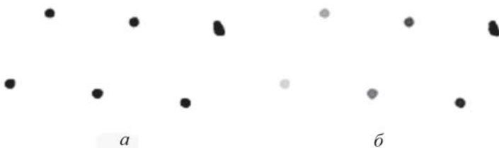
Рис. 15. Пример разметки связных областей: a — исходное изображение; б — размеченное изображение
