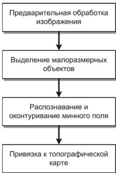
Рис. 5. Блок-схема обработки изображений минных полей
