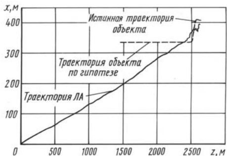
Рис. 9. Процесс наведения ЛА по прогнозируемой траектории движения объекта
