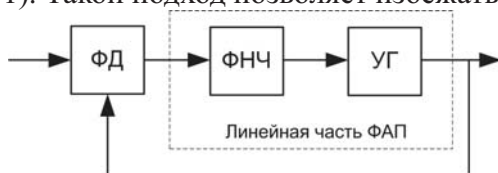
Рис. 1. Функциональная схема обобщенной системы ФАП
