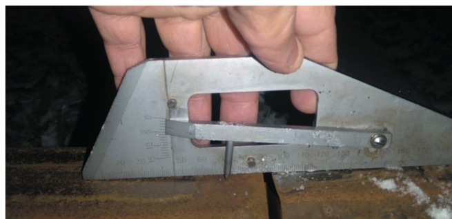
Рис. 5. Графическое представление зарегистрированной вертикальной ступеньки в виде облака точек красного цвета (а), контрольный замер вертикальной стыковой ступеньки с помощью линейки Шестопалова (б)
