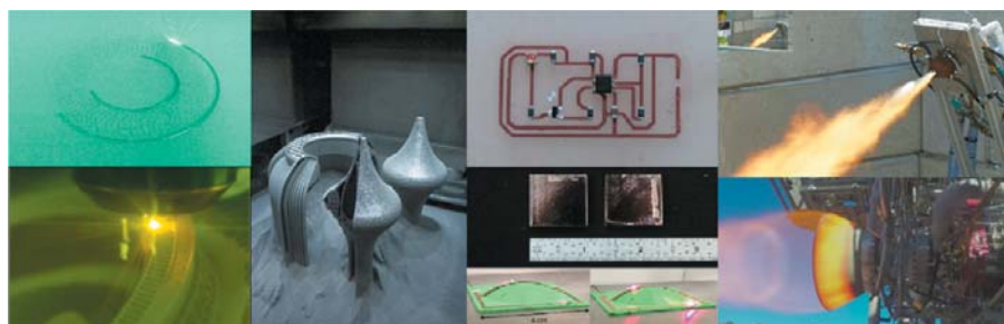
Рис. 1. Металлические структуры и изделия, синтезированные с помощью аддитивной технологии SLM
