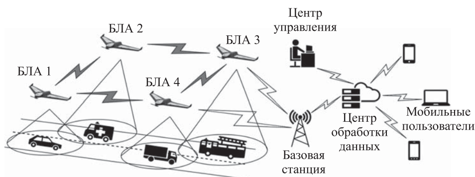
Рис. 3. Пример использования сети FANET для контроля дорожного движения
