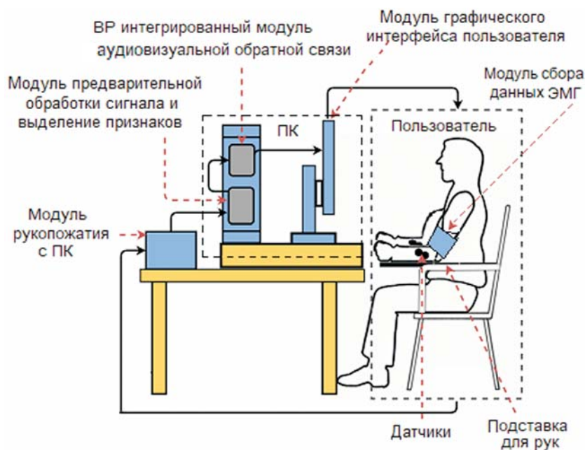
Рис. 3. Компоненты мобильной платформы виртуальной реальности на основе биологической обратной связи по данным ЭМГ
