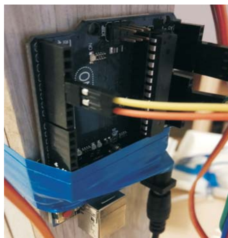
Рис. 6. Микроконтроллер Arduino Uno (фото автора)
