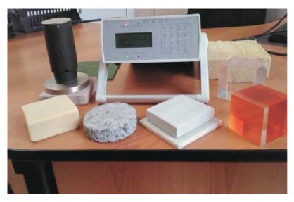
**Рис. 4.** Реконфигурируемая ИИС неразрушающего контроля ТФС материалов с интеллектуальным датчиком
