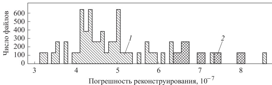
Рис. 6. Распределение погрешности реконструирования нормальных (1) и аномальных (2) звуков
