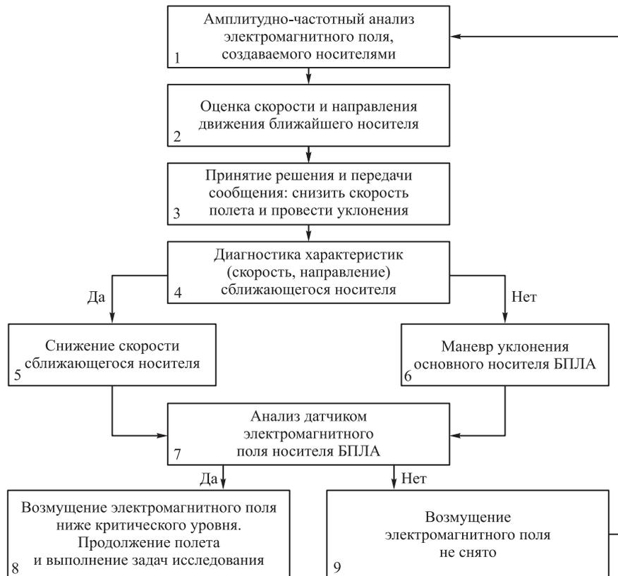
**Рис. 9.** Принципиальная блок-схема алгоритма решения задачи специального программного обеспечения, позволяющего предотвратить опасное сближение БПЛА
