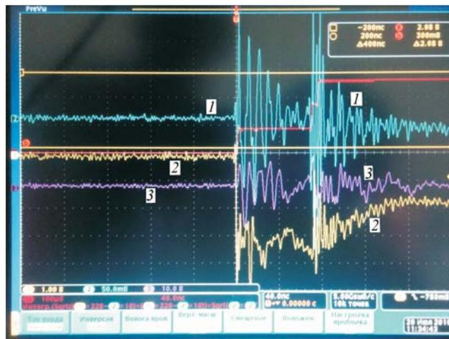
**Рис. 6.** Фото с экрана осциллографа, регистрирующего изменение во времени ЭДС (3), возникающую в соленоиде при излучении электромагнитного поля вибратором:
