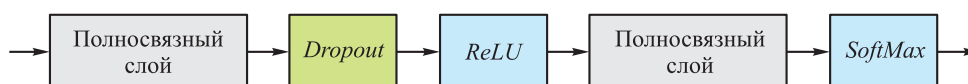
Рис. 2. Структура, добавленная вместо выходного слоя в каждую из базовых архитектур нейронных сетей
