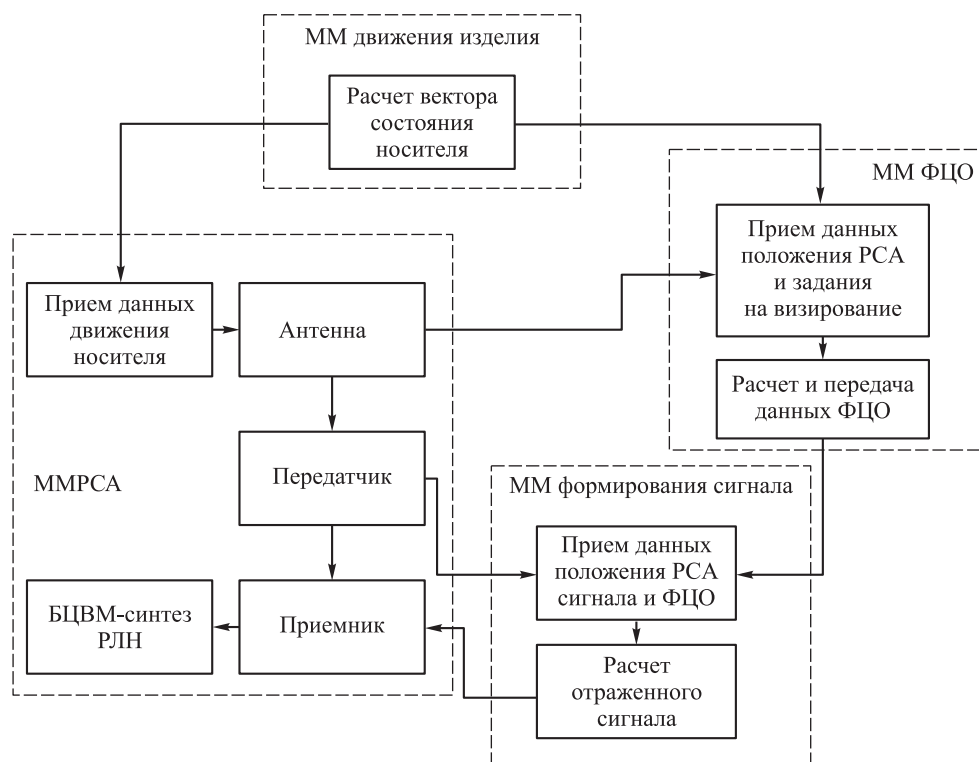
Рис. 7. Стенд математического моделирования РСА
