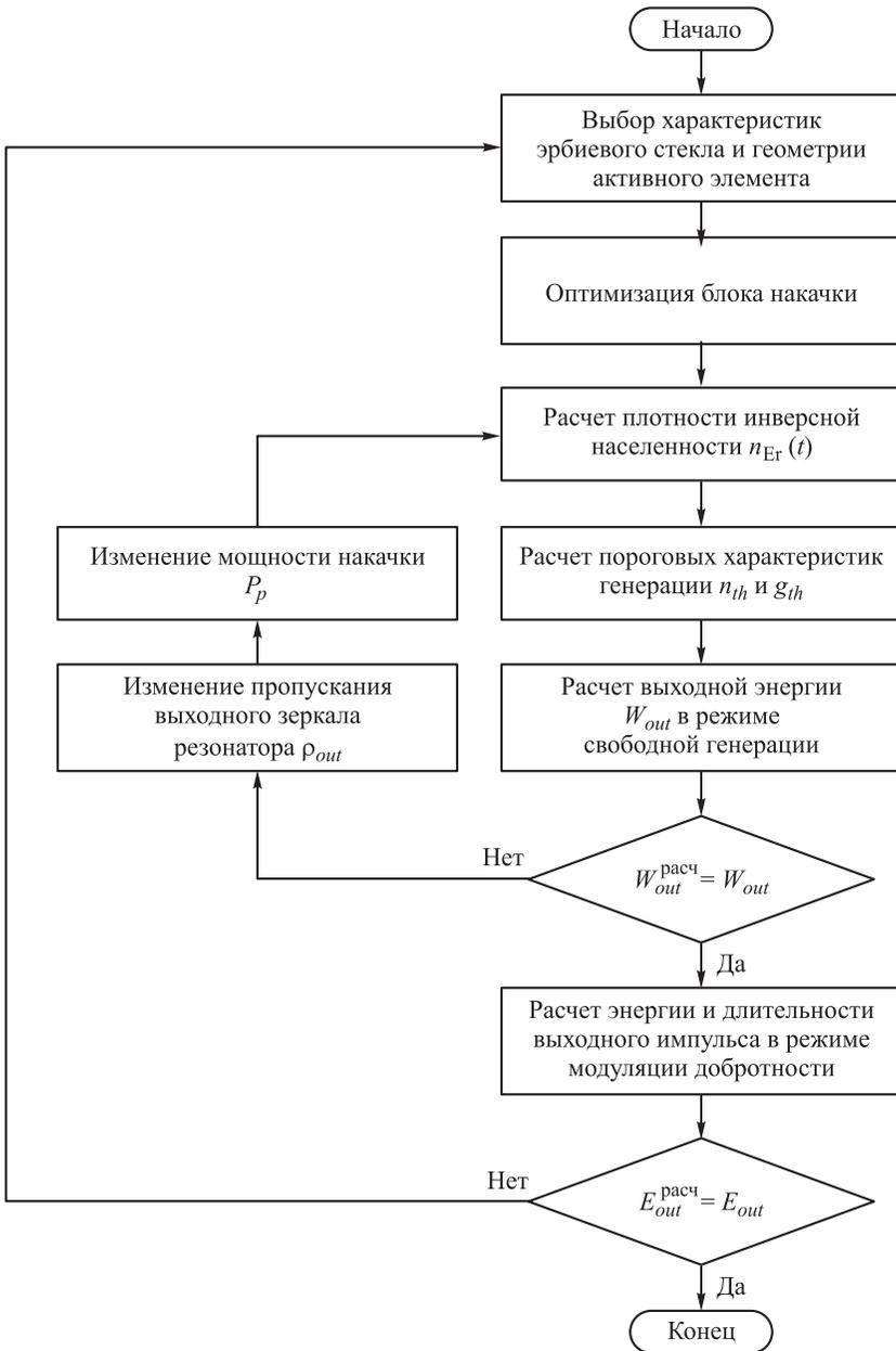
Рис. 6. Блок-схема алгоритма методики расчета эрбиевого лазерного излучателя
