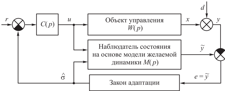
Рис. 4. Общая схема адаптивного контура управления
