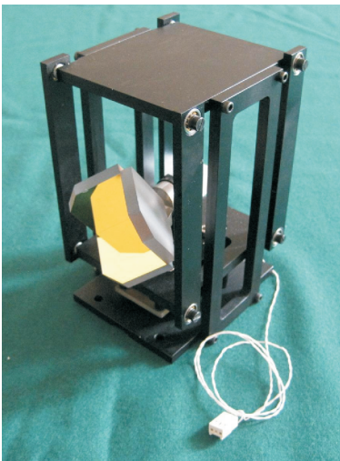
Рис. 3. Параллелограммное механическое устройство перемещения подвижного отражателя
