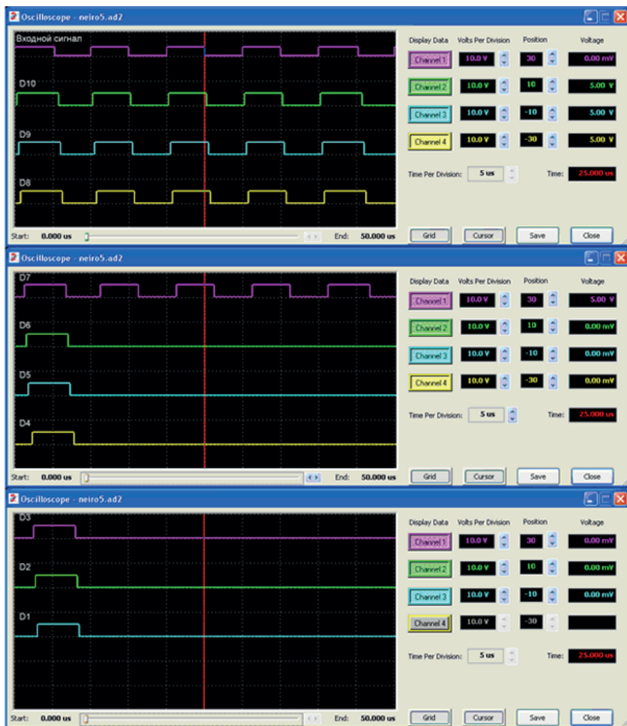
Рис. 6 (начало). Временные диаграммы работы преобразователя на интервале времени 20 мкс при сигнале 3,75 (а) и 1,64 В (б)
