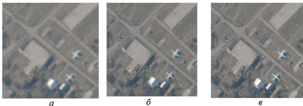
Рис. 3. Изменение качества изображения при смене условий применения при дешифрировании до класса самолет H = 6000 м (а), до вида транспортный самолет H = 3000 м (б) и до типа самолета Ан-26 H = 1500 м (в)
