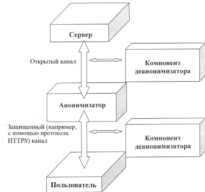
Рис. 1. Принципиальная схема работы анонимизатора
