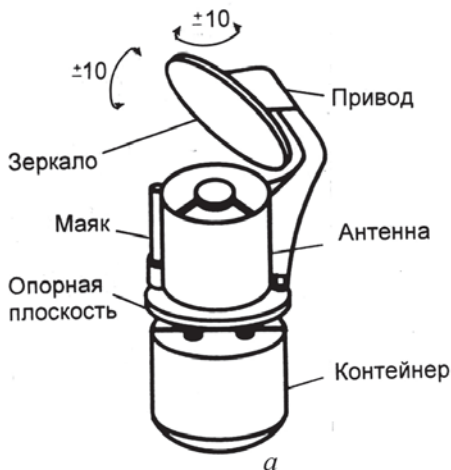
Рис. 2. Ориентировочный облик терминалов; технические характеристики: масса — 70 кг, габаритные размеры — 400 × 400 × 800 мм, энергопотребление в сеансе связи — 200 Вт, точность выдачи пеленга корреспондента в сеансе связи — 5 угл. с, ширина диаграммы излучения — 2...4 угл. с
