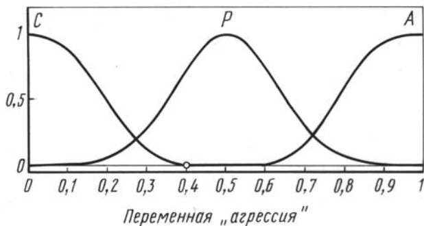
Рис. 11. Функции принадлежности нечеткой переменной “агрессия” (значения — водитель спокойный (С), раздраженный (Р), агрессивный (А))
