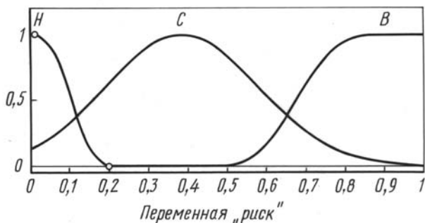
Рис. 10. Функции принадлежности нечеткой переменной “риск” (значения — низкий (Н), средний (С), высокий (В))
