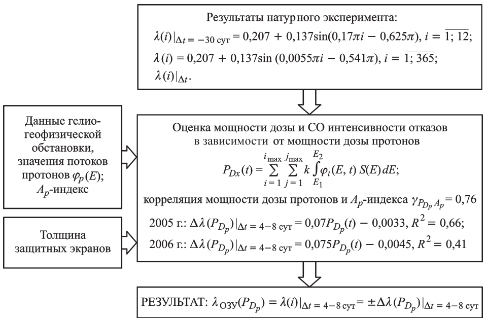
Рис. 5. Схема модели для оценки надежности типовой БВС по отношению к перемежающимся отказам
