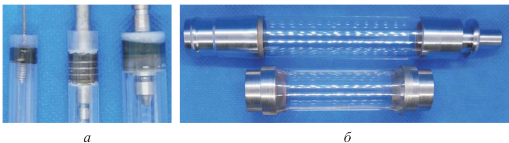
Рис. 8. Конструктивное исполнение спаев сапфир–ниобий ( а ) и сапфир–ковар ( б ), используемых в серийных изделиях [1, 2]
