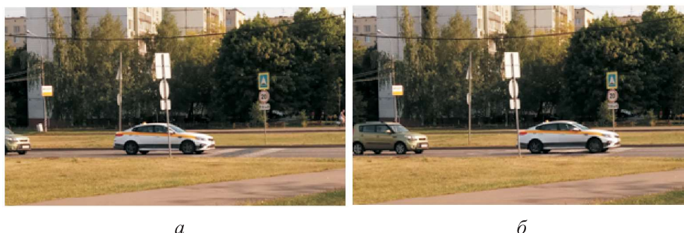
Рис. 5. Движение автомобиля через искусственную неровность с известными размерами поперечного сечения: a — перед искусственной неровностью, б — передняя колесная ось на искусственной неровности
