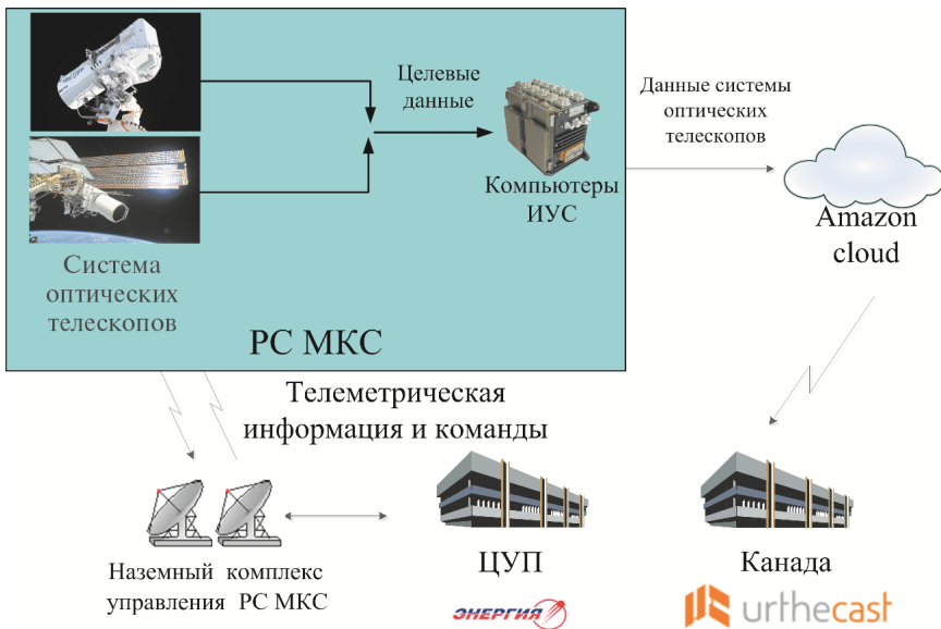
Рис. 7. Схема передачи информации на Землю с борта МКС, реализованная в рамках космического эксперимента «Напор-мини РСА»
